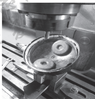
图 5 钼管堵芯隔膜加工
